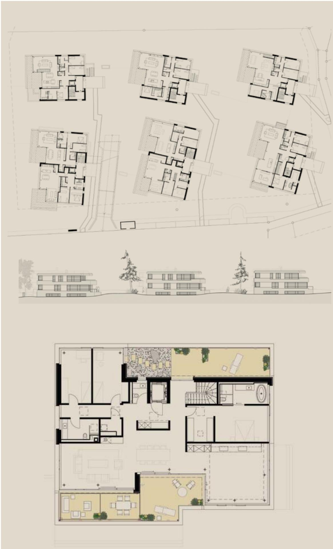
Im Grundriss wird die versetzte Anordnung der Mehrfamilienhäuser deutlich, die sowohl Durchblicke als auch Privatsphäre ermöglicht.
